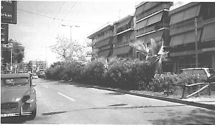
Σχήμα 5. Χτυπητό παράδειγμα θετικής προσπάθειας αντιμετώπισης, με πλούσια ειδική φύτευση, των ποικίλων ρυπάνσεων στην οδό Πέτρου Ράλλη. Μόνο που το φυτευτικό αυτό φράγμα έχει δημιουργηθεί ανάμεσα από τις δύο λωρίδες του οδοστρώματος και όχι ανάμεσα στους πεζούς (στα πεζοδρόμια) και στους τροχούς (στο οδόστρωμα)
