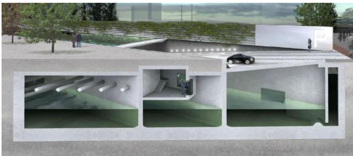
Σχ. Γ2.30. Υπόγειος χώρος στάθμευσης στο museum Park του Ρότερνταμ με πρόβλεψη για συγκράτηση υδάτων σε περίπτωση υπερχειλίσιας των καναλιών λόγω έντονης βροχόπτωσης. Πηγή: https://www.rotterdam.nl/wonen-leven/waterberging-museumparkgarage/
