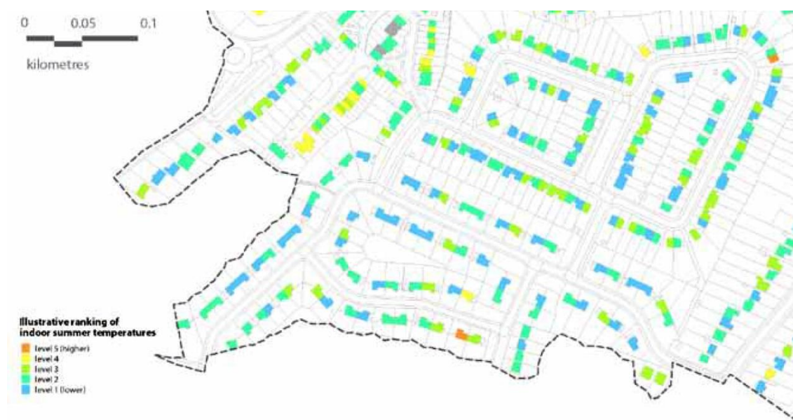
Σχ. Β3.1. Απεικόνιση του κινδύνου υπερθέρμανσης ανά κτίριο βάσει του προγράμματος LUCID.
