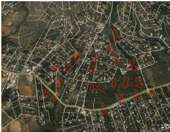
Εικ. 2.2. Ανύσματα της ανεμπόδιστης εξάπλωσης της πυρκαγιάς χαρτογραφημένα με τη βοήθεια εικόνων από ΣμηΕΑ από το Νέο Βουτζά προς το Μάτι (Πηγή: Lekkas et. al, 2018).
